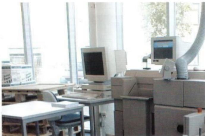
Die Druckmaschinen sind in ein Netzwerk eingebettet und arbeiten mit einem Ausstoß von bis zu 180 Seiten im Format A4 pro Minute. Beim Format A3 reduziert sich der Ausstoß auf 77 Seiten pro Minute. Bei den großen Druckstraßen können die Bücher entweder geheftet oder mit einer Thermoklebebindung versehen werden.
